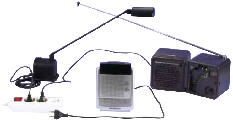
B2 Stromkreis im Haushalt: Alle Geräte sind parallel an dieselbe Stromquelle angeschlossen.
