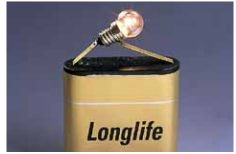
B1 Der einfachste geschlossene Stromkreis
