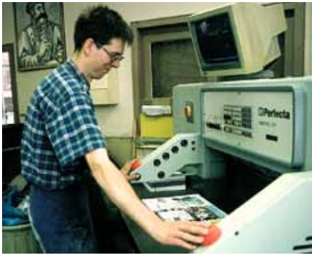
B1 Beide Schalter müssen betätigt werden.
