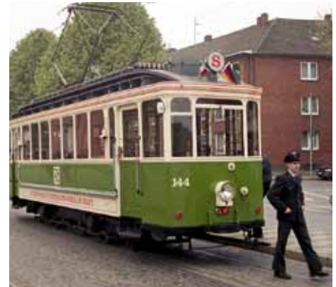
B5 Die Motoren dieser historischen Straßenbahn waren in Reihe geschaltet.
